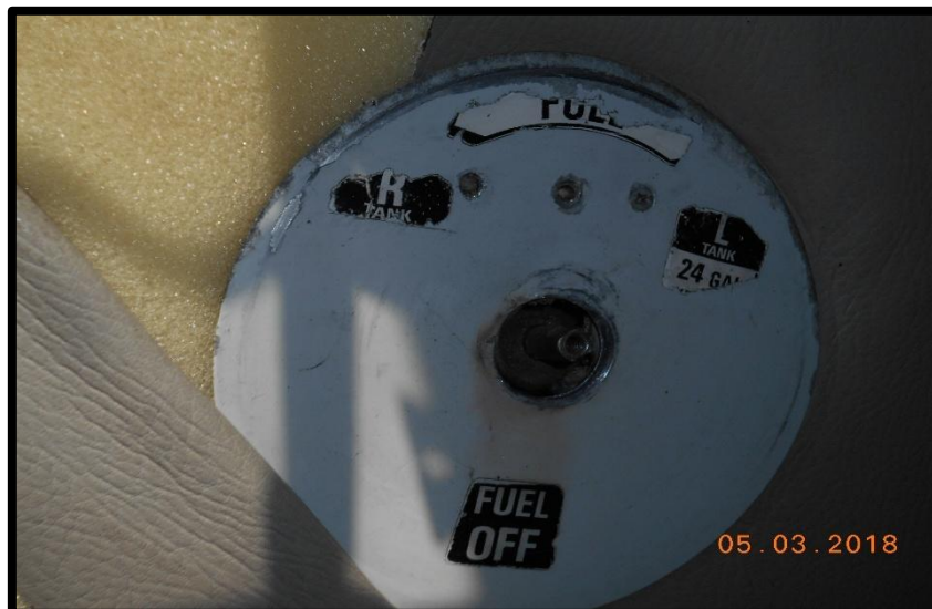
Fotografía No. 12 Vista de la válvula selectora de combustible sin la manecilla.
