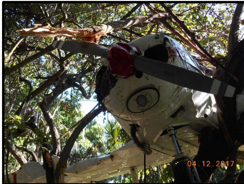
Fotografía No. 10 Vista de los daños a las aspas de la hélice.
